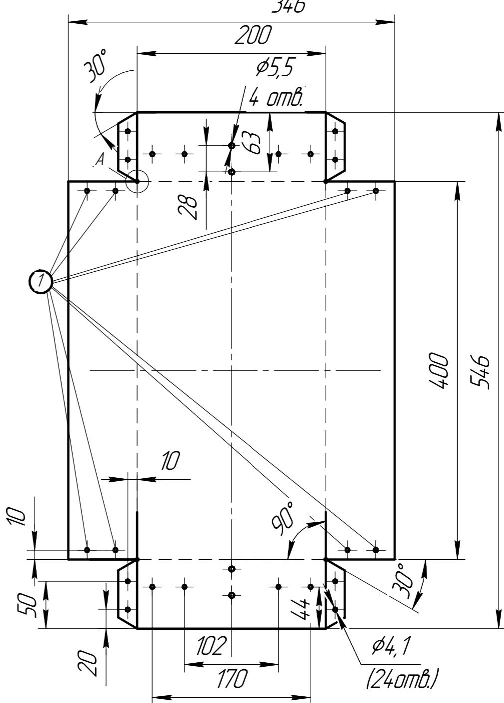
1. Неказанные предельные отклонения размеров охватываемых поверхностей  $h14$ , прочих  $\pm T14/2$ .
