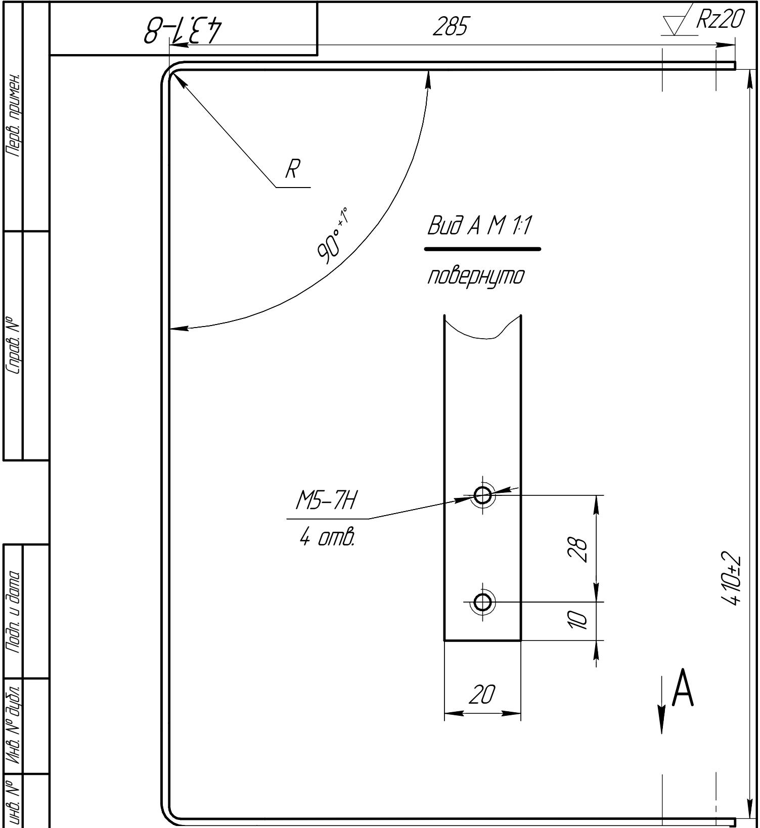
1. Неуказанные предельные отклонения размеров охватываемых поверхностей  $h12$ , охватывающих поверхности  $H12$ , прочих  $\pm IT12/2$ .
